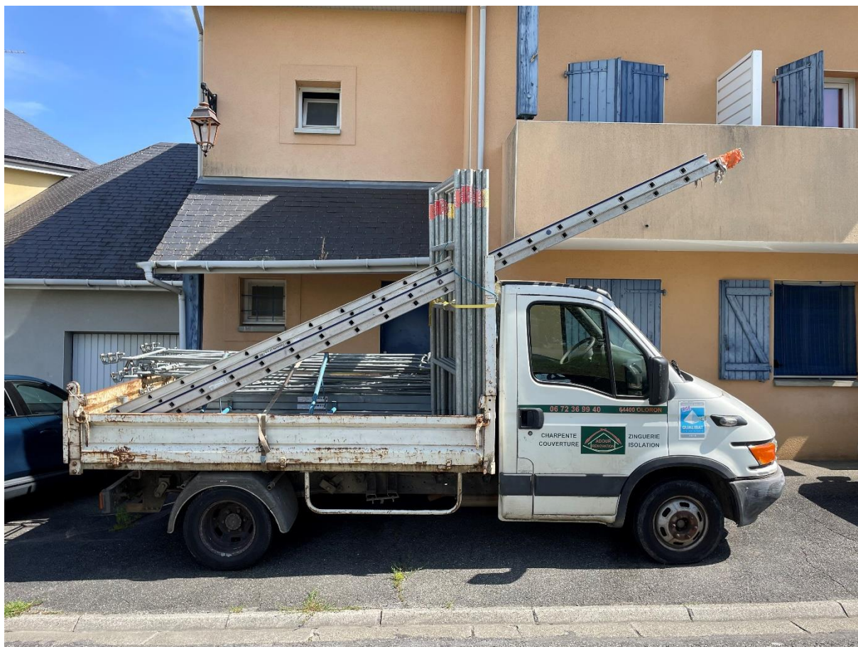
Un échafaudage ALTRAD comprenant 12 échelles garde-corps, 8 plateaux COMABI, Echelle GS deux pans aluminium
